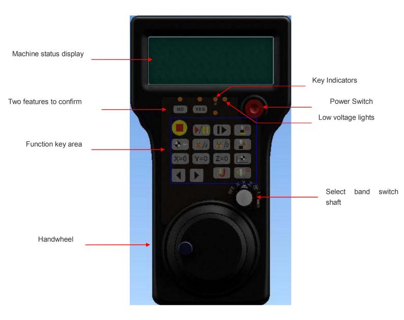
备注: 当低压指示灯亮的时候, 表示电池电量快用完了, 建议更换电池。
